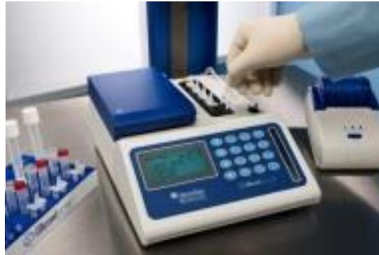
Appareil : bloc chauffant fluorimètre ou turbidimètre
